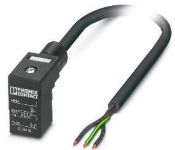
Ventilstecker mit Freilaufdiode, Bauform C, 3-polig
