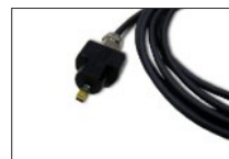
RFTO-325 - Spezialfühler für Feuchte-/Temp.-Messung an Wand- und Grenzschichten im Bereich -20...+80°C. Abmessungen D=30mm x H=10mm
