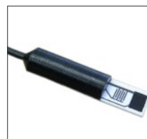
SHSW-325 - Spezialfühler zur Detektion von Benetzung bzw. Wassereinbruch. Wasserschalter liefert Signal 1, wenn Wasser detektiert wird und 0 wenn der Sensorbereich trocken ist. Abmessungen: 60 x 10mm
