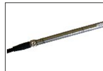
RFT-325 - Fühler zur Messung von Luftfeuchte und Temperatur. Einsatz bei -20... +80°C bzw. -40/+120°C mit Spezialkabel Typ G. Abmessungen: D=8x35mm
