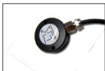
RFTO-325 - Spezialfühler für Feuchte-/Temp.-Messung an Wand- und Grenzschichten im Bereich -20...+80°C. Abmessungen D=30mm x H=10mm
