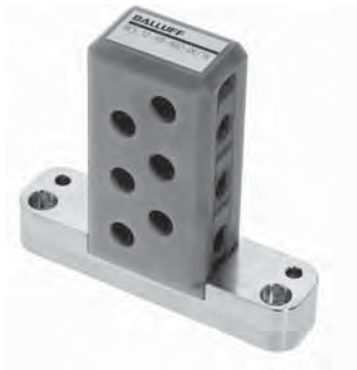
Klemmbock für Sensoren M12 bündig einbaubar mit Teilung 16 mm, für Nockenleiste mit Teilung 16 mm
