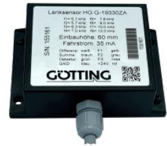
Für die Spurführung von fahrerlosen Transportfahrzeugen (FTF) haben sich induktive Systeme bewährt und ihre Zuverlässigkeit gezeigt. Ein Frequenzgenerator speist einen Strom in einen im Boden verlegten Leitdraht. Entlang des Leitdrahts bildet sich ein wechselseitiges magnetisches Feld. Der Sensor erkennt die horizontalen und vertikalen Anteile dieses Felds mit Hilfe spezifischer Spulen.
