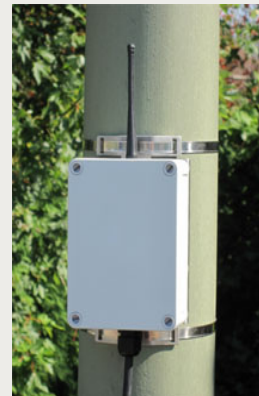
Beispiel: Gateway mit Masthalterung
