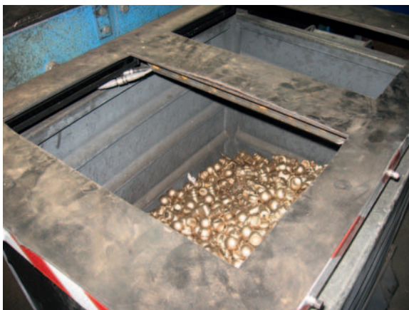
Anwendung der Lichtgitter in einer Auswurfkontrolle von Heizungsventilen. (Teilezählung)
