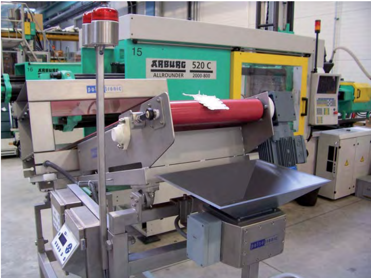
Digital+ KS 100 zur Kernbruchkontrolle am nachgeschalteten Förderband einer Spritzgussmaschine. (Abbildung mit vorgeschalteten Tunneldetektor)
