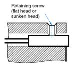
Clamping torque: 0.98 Nm max.
