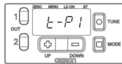
2. Bringen Sie das Schaltobjekt in den Arbeitsbereich des Sensors und betätigen Sie die Tune- Taste ein weiteres Mal.
