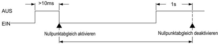
Beim Wiedereinschalten der Stromversorgung wird der Nullpunktgleich von einem externen Eingang deaktiviert. Diese Nullpunkteinstellung ist nicht gespeichert.
